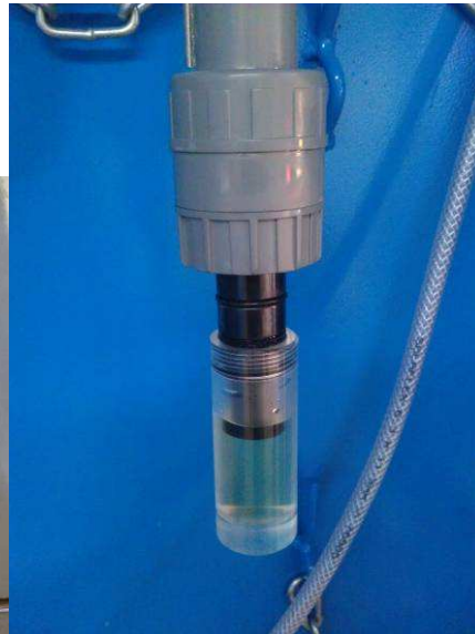
Schraub-Abdeckung aus Plexiglas (mitgeliefert), Elektrode in der Flüssigkeit
